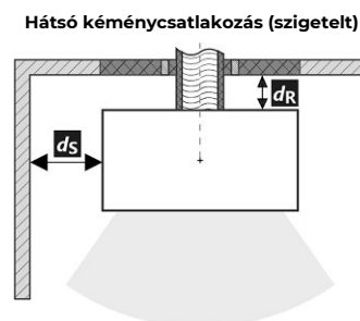
A füstcső áthaladása éghető anyagból készült falon
