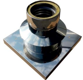
Nástavec je složený z přechodové desky, rovných dílů požadované délky a ukončovacího dílu se stříškou. Jednotlivé díly se mezi sebou spojují zasunutím a následnou fixací pomocí spojky.
