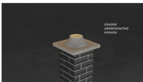
25. Osazení ukončovacího konusu
