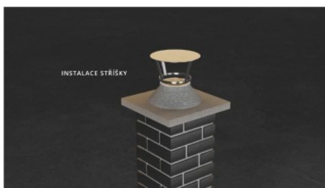
26. Instalace komínové stříšky
