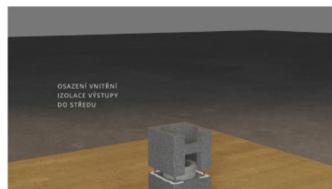
06. Osazení vnitřní izolace
